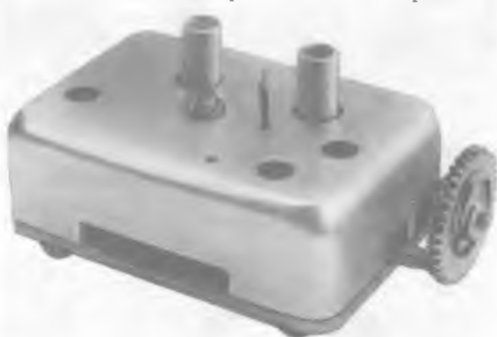
Блок УКВ с индуктивной подстройкой. Фото 2014 года
